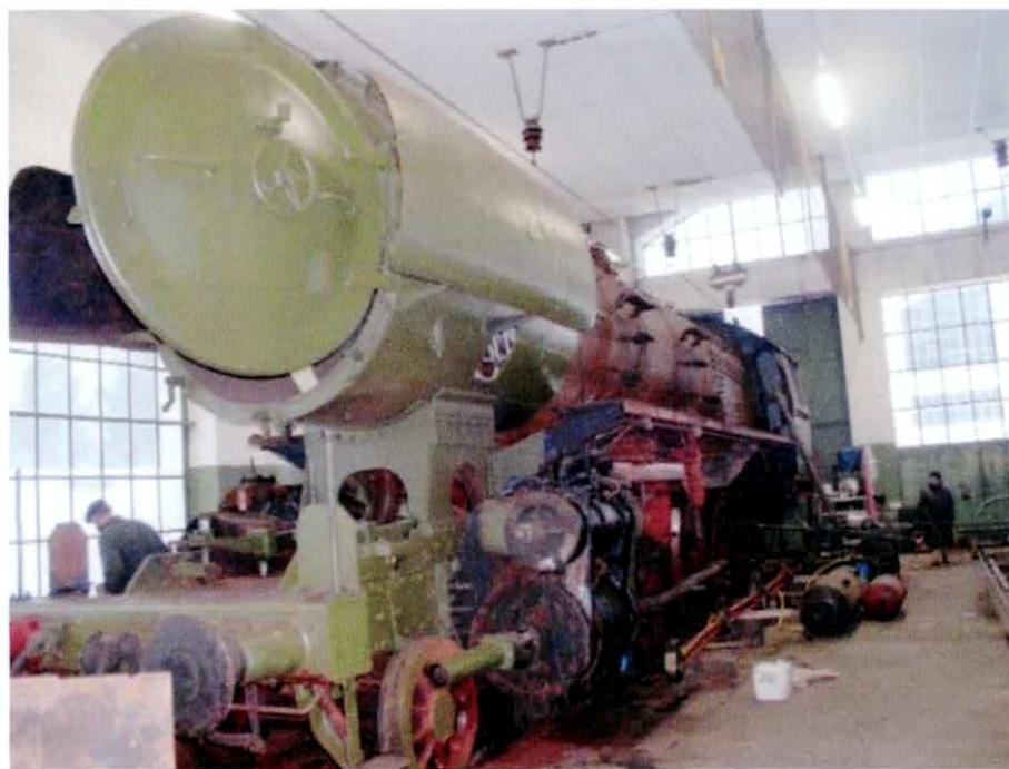
*L'épreuve de mise en pression a nécessité une préparation très importante de démontage. La chaudière est « le cœur » d'une locomotive à vapeur. La remise en état de la chaudière est une opération très coûteuse et souvent malheureusement synonyme de la mise à la ferraille de la machine.*
